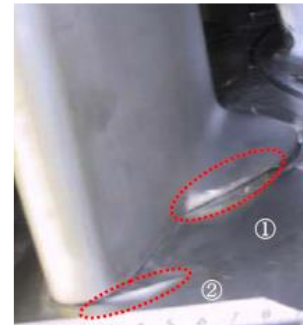
水車の摩耗状況とCFD解析の例
