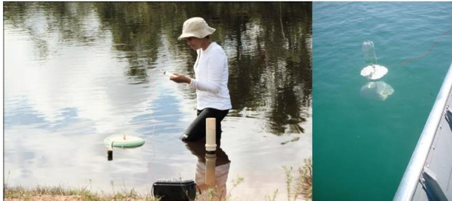
図 B5ー浮遊拡散チャンバの設置 (1,000mL)
