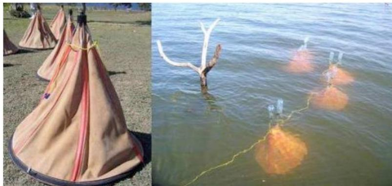
図 B1－気泡採取漏斗構成の詳細
