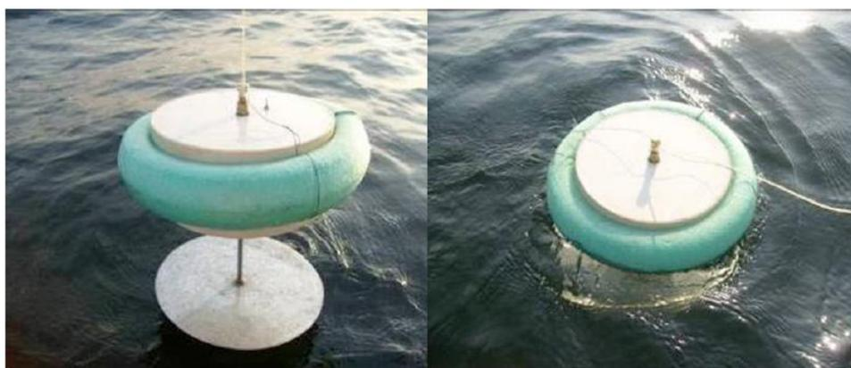
図 B4—浮遊拡散チャンバの詳細 (1,000mL)
