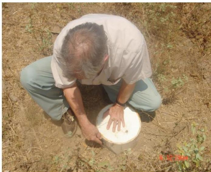
図 B7ー土壤中へのチャンバの設置
