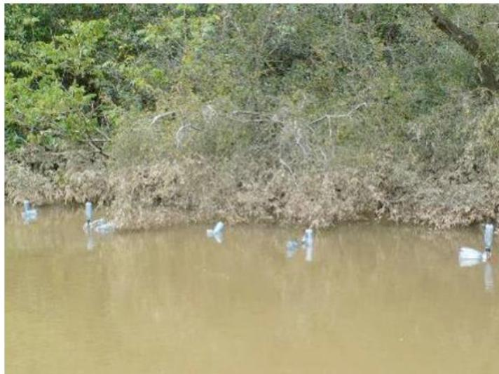
図 B3—岸に近い区域に設置された漏斗
