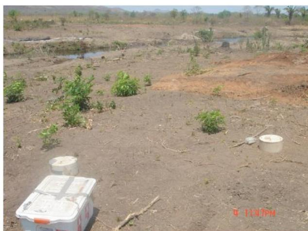
図 B8ー土壤中のチャンバによる温室効果ガスの採取
