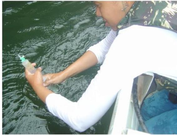
図 B10—ヘッドスペース分析のための、ダム壁から下流の水サンプルの採取
